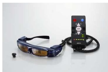
世界でも稀な夜盲症と視野狭窄の方を対象とした眼鏡型のウェアラブル機器です。HOYA が独自開発した小型低照度高感度カメラで捉えた像を明るい映像として装用者の左右の目の前に配置された有機 EL ディスプレイに投影します。赤外線カメラと違い、暗所でのわずかな光を増幅させているので、対象物の色彩を自然に再現します。
