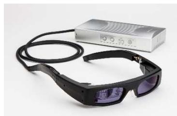
眼鏡型のフレームに内蔵された超小型プロジェクタから、網膜に直接映像を投影するヘッドマウントディスプレイです。ピントの位置や屈折異常(近視、遠視、乱視、老眼など)に影響を受けにくいのが特長です。片眼の視野中心部に HDMI 接続した機器からデジタル映像を投影できます。
